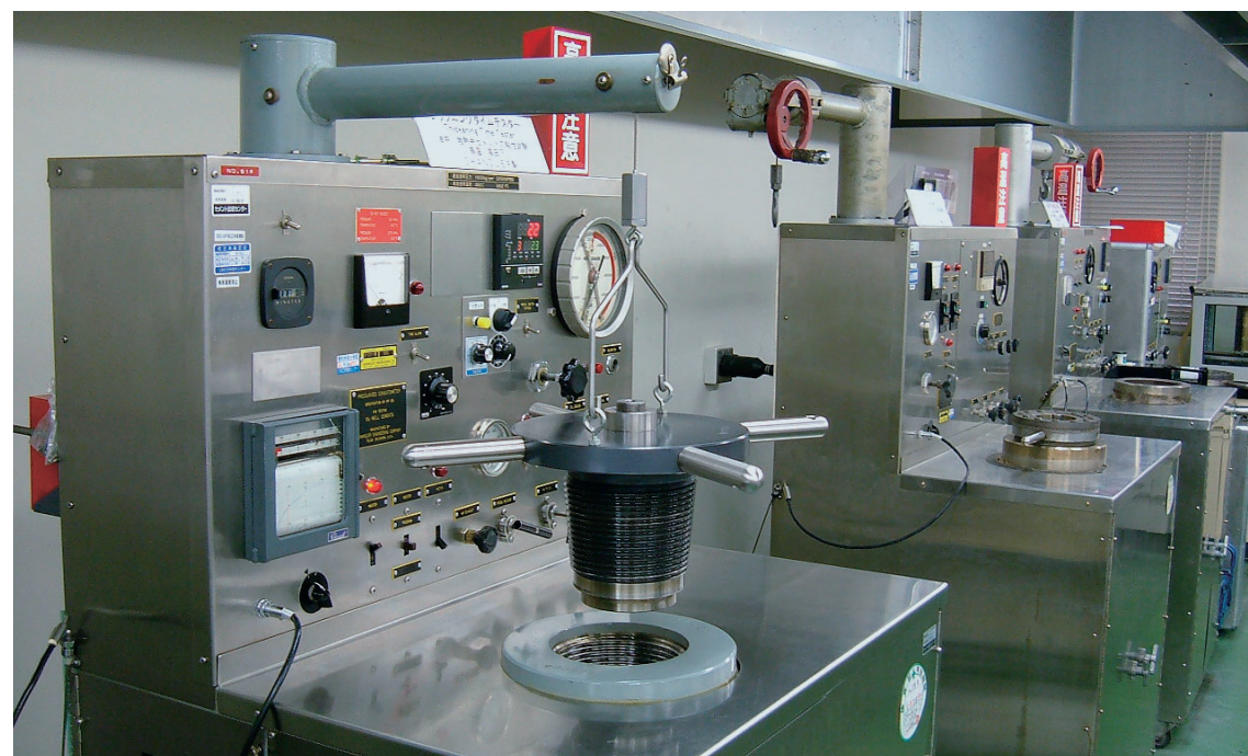
手前/高温高圧コンシステーター 後方/圧縮強度試験用供試体の高温高圧養生槽
