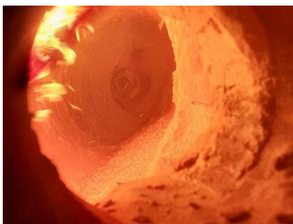
写真1 連続製造時のロータリー式炭化炉の内部
