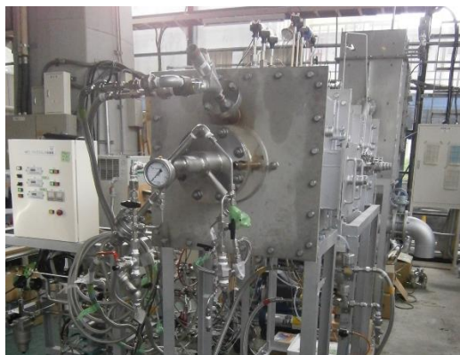
写真1 10kW 小型工業炉
