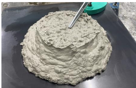
図1 高炉スラグ微粉末を高含有した コンクリートの例
