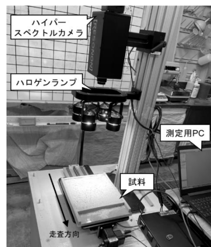
写真 1 ハイパースペクトルカメラ撮影状況
